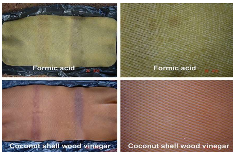
Hình 2. Cao su tờ bán khô (trái) và bề mặt của nó (phải) - đông tụ bằng axit formic và giấm gỗ gáo dừa.
