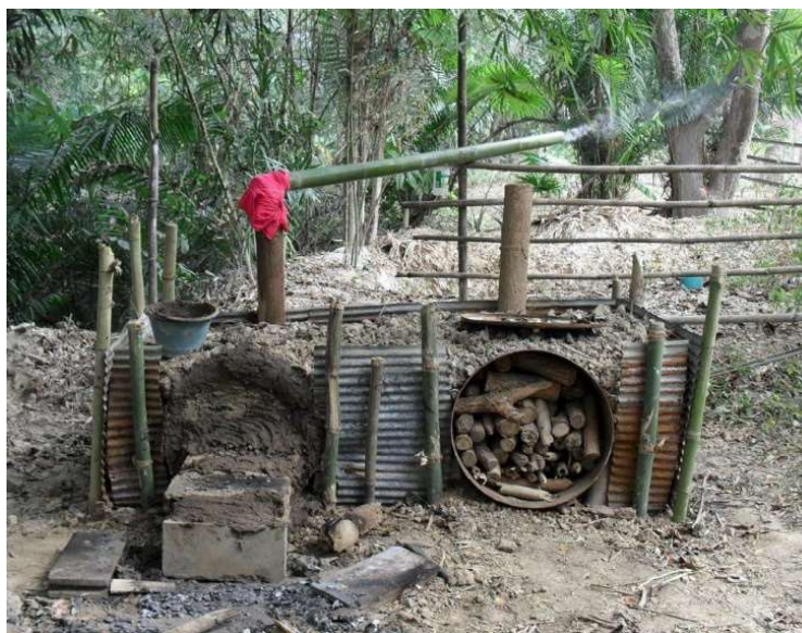
Hình 1. Sản xuất giấm gỗ bằng lò thùng 200 lít
