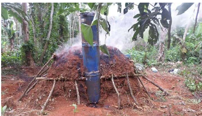
Hình 2. Sản xuất giấm gỗ bằng lò Casamance
